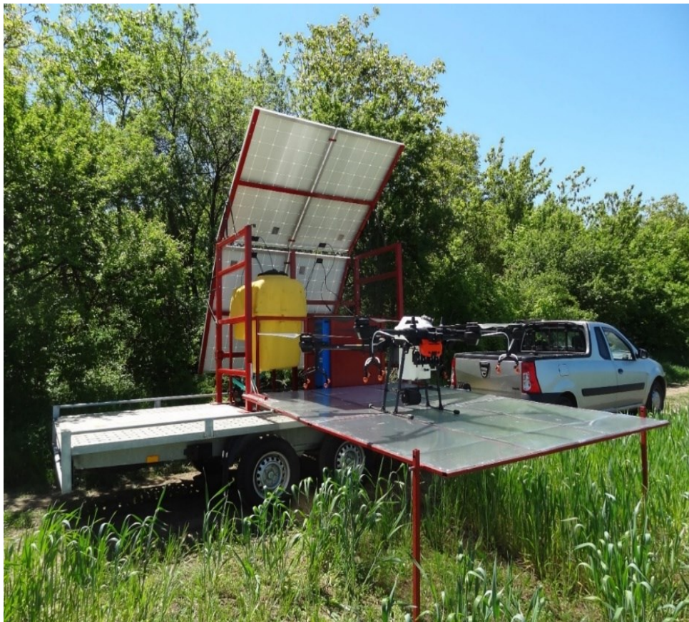
Fig. 1 - Sistem pentru protecția culturilor de câmp conform “agriculturii 4.0” destinat FERMEI SMART
