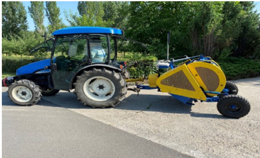
Fig. 1 - Mașină de balotat corzi de viță de vie
