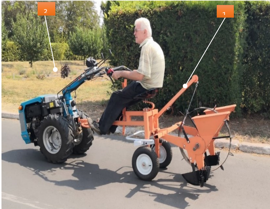
Fig. 1- Modelul experimental al echipamentului pentru semănat plante tehnice, SPT- 1. - Echipament SPT; 2. - Motocultor
