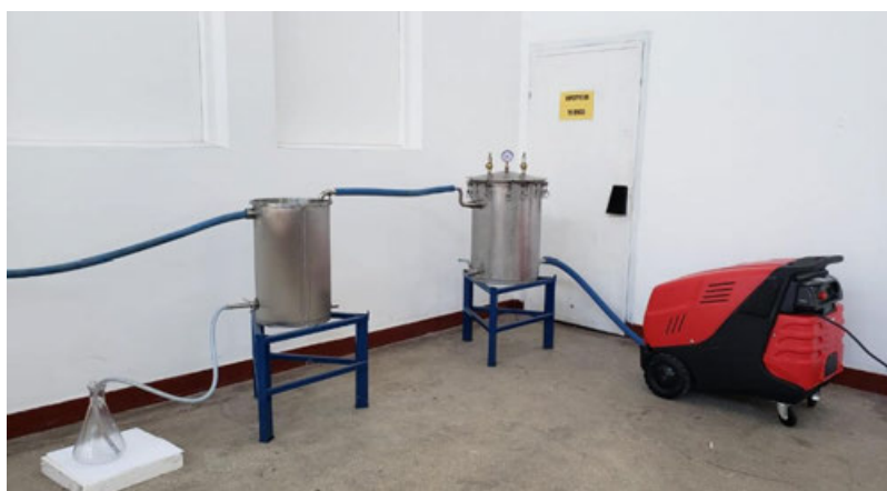
Fig. 1 – Modelul experimental de echipamentului tehnic E.D.A.S.U.P – echipament de distilat cu abur saturat umed sub presiune (ADER 25.4.1)
