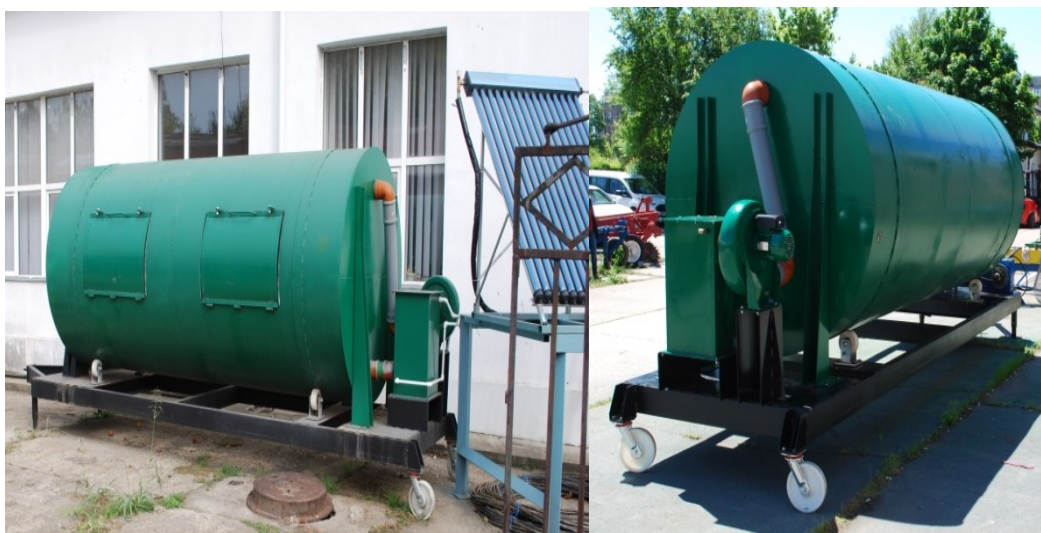
Fig.1b - Instalația de recuperare a energiei termice din compost, IRTC
