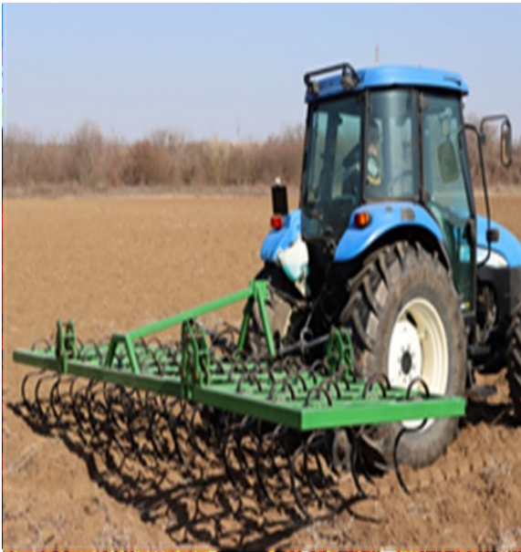
Fig.1-2 - Echipamentul MCLS în stare desfășurată, pentru lucru, (stânga) și în stare pliată, pentru marș (dreapta).
