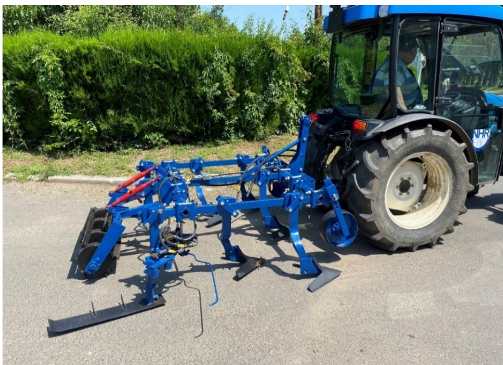
Fig. 1 - Echipament de prășit pe rând și între butucii de viță de vie
