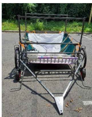
Fig.1 - Echipamentul multifuncțional de recoltat plante medicinale, cuplat la tractor EMR
